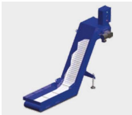
Os transportadores tipo esteira articulada, formato com maior número de aplicações, oferecerem uma eficiente capacidade de gerenciar cargas pesadas de cavacos ou cavacos espirados. Os cavacos gerados na usinagem da máquina caem sobre a esteira e são afastados da área de precisão da máquina
