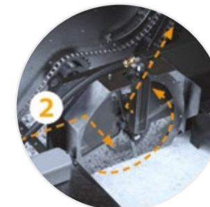
Um jato contínuo de fluido filtrado é direcionado contra o elemento de aço inoxidável, removendo cavacos e borras. Os bicos são de fácil acesso para sua manutenção ou substituição.
