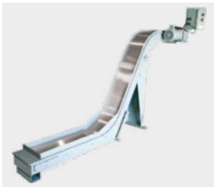
Os transportadores de cavaco magnéticos são destinados a aplicações que geram pequenos cavacos metálicos ferrosos. Os cavacos caem sobre a superfície inoxidável e são arrastados por meio de potentes imãs que se movem sob esta superfície. Os cavacos são liberados do imã, na área de descarregamento e caem na caçamba coletora.
