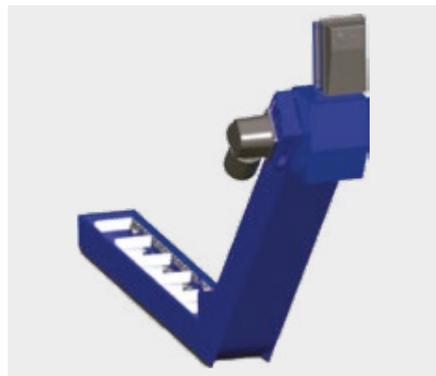
Os transportadores tipo corrente de arraste são, na maior parte das aplicações, utilizados em usinagens de ferro fundido, alumínio, bronze ou latão, que produzem pequenos cavacos que podem aglomerar-se. Os cavacos depositam-se diretamente no fundo do transportador e são arrastados para a extremidade de descarregamento do transportador.
